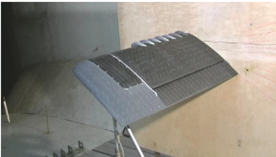
Рис. 2.6. Общий вид модели МОК с установленными щелевыми закрывками.
