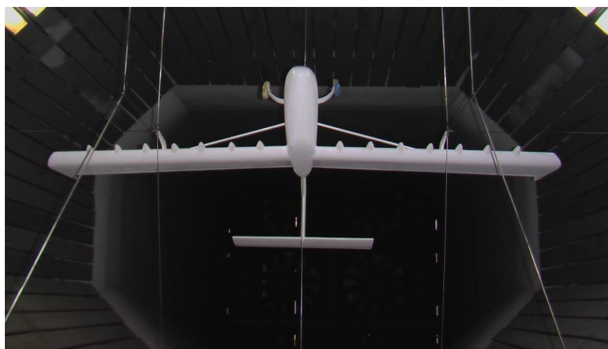
Рис. 4.25. Модель самолета в рабочей части аэродинамической трубы во время эксперимента.
