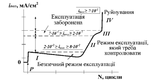
Стадії корозійно-втомного руйнування сталі 08X18H10T:
